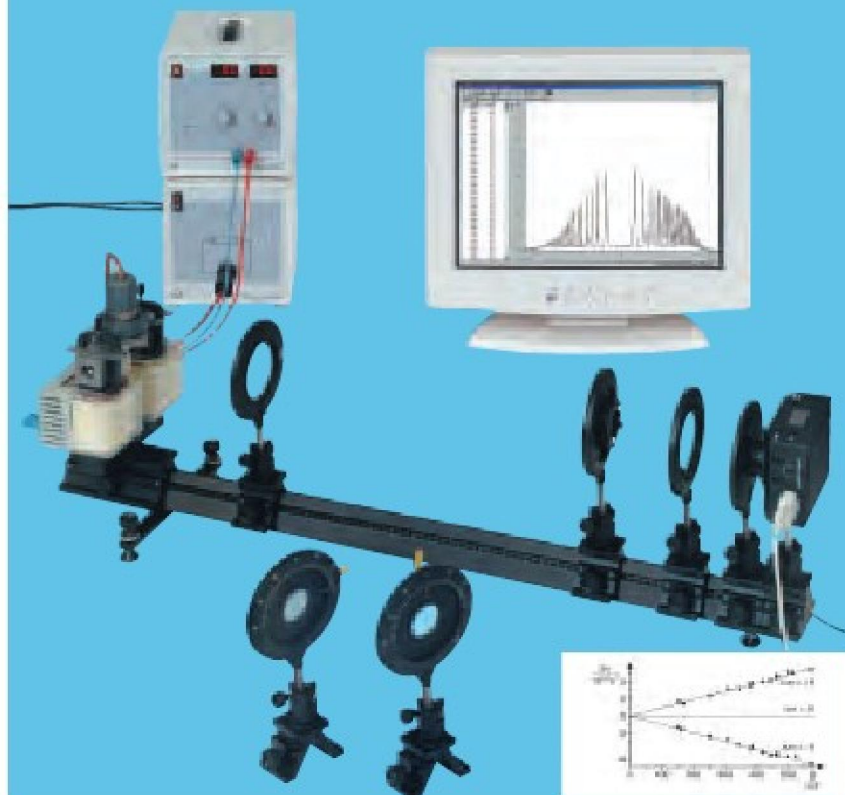
Pomiar rozszczepienia Zeemana czerwonej linii kadmu w funkcji pola magnetycznego spektroskopu z użyciem etalonu Fabry-Perota (P6.2.7.4_b)
