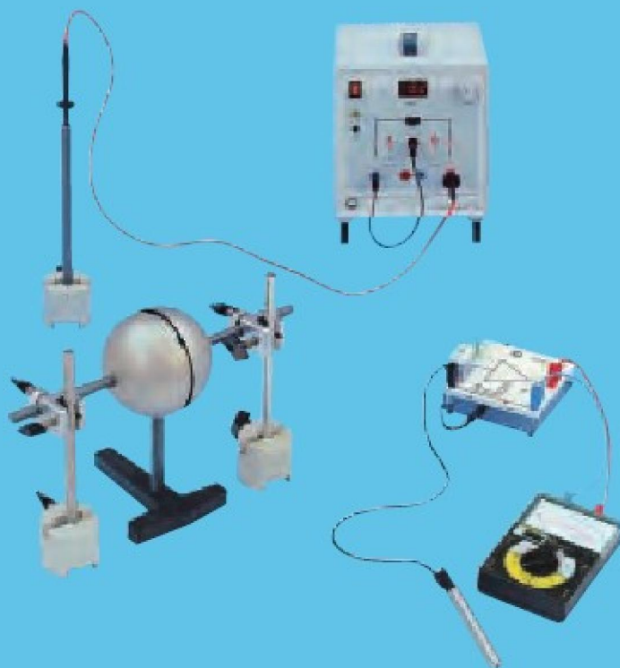
Indukcja elektrostatyczna półkul według Cavendisha (P3.1.5.2)
