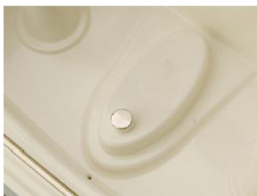
Czujnik temperatury zamontowany w komorze pomiarowej testera nowej serii Megger OTS
