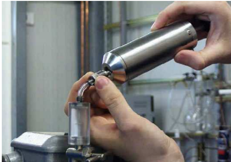
Rys.3. Sposób pobierania gazu z przekaźnika
