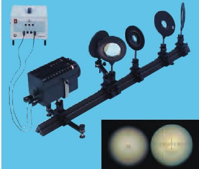
Pierścienie Newtona w przechodzącym świetle monochromatycznym (P5.3.3.2)
