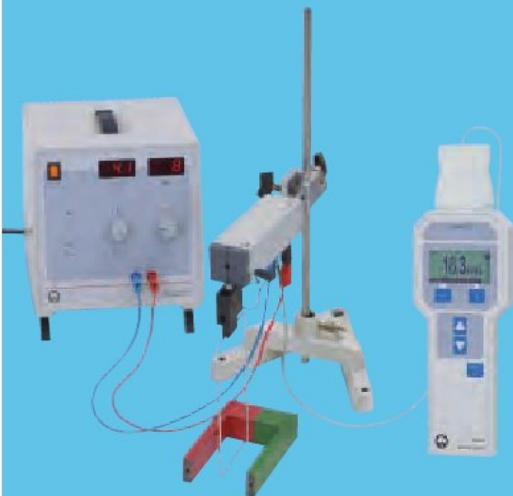
Pomiar siły działającej na prąd w przewodach pod wpływem magnesu w kształcie podkowy (P3.3.1_b)
