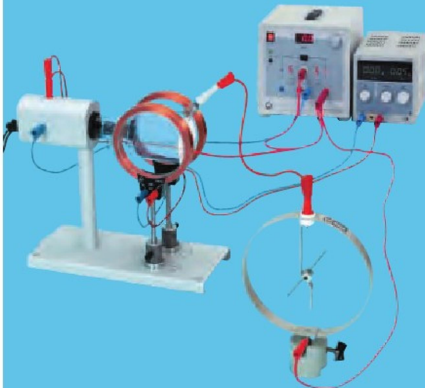
Emisja gorącej katody w próżni: Ustalenie biegunowości i oszacowanie ilości emitowanych nośników ładunku (P3.8.4.1)
