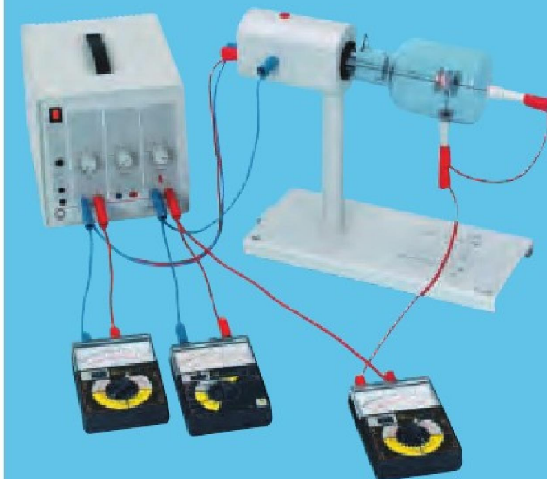
Niesamoistne wyładowanie w gazach: porównanie pomiędzy przesyłaniem ładunku w triodzie gazowej triodzie o wysokiej próżni. (P3.9.1.1)
