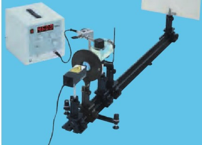
Optyczne określenie prędkości dźwięku w cieczach (P1.7.8.1)
