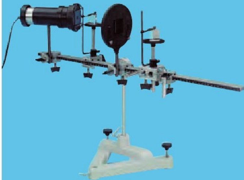
Eksperymenty Newtona odnośnie rozszczepienia i ponownego łączenia światła białego (P5.2.2.1)
