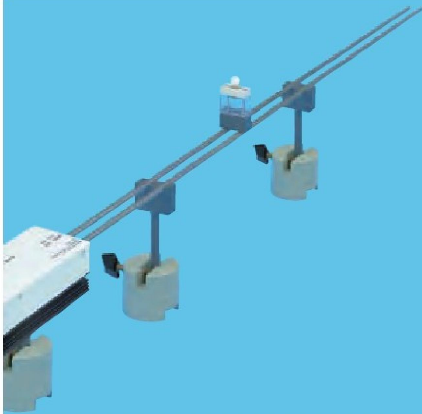
Ustalenie maksymalnych wartości prądu i napięcia na linii Lechera. (P3.7.3.1)
