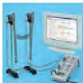
Sprężone wahadło – Rejestracja oraz analiza za pomocą CASSY (P1.5.4.4)
