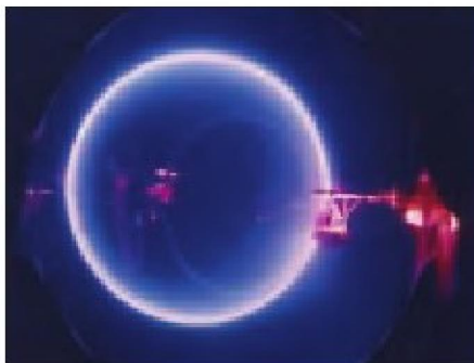
Okrężny ruch elektronów w rurze świetlnej
