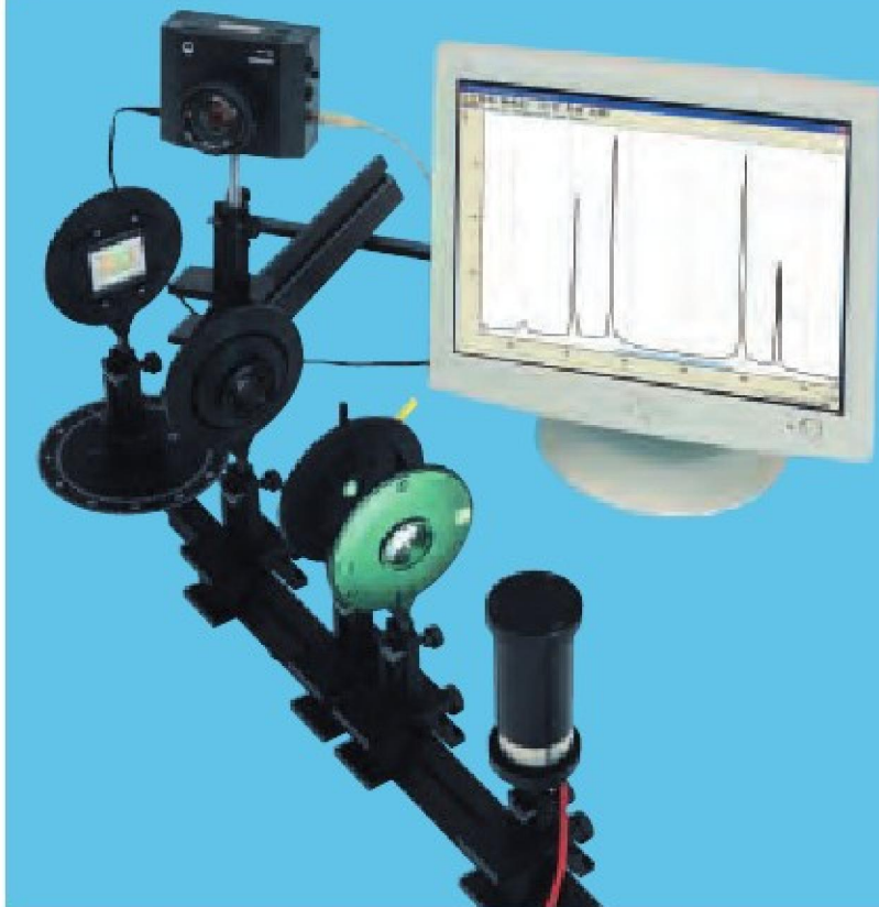
Podłączenie spektrometru siatkowego w celu pomiaru linii widmowych (P5.7.2.3)
