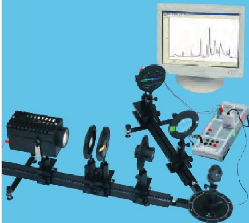
Badanie widma lampy ksenonowej z siatką hologramową (P5.7.2.5_b)
