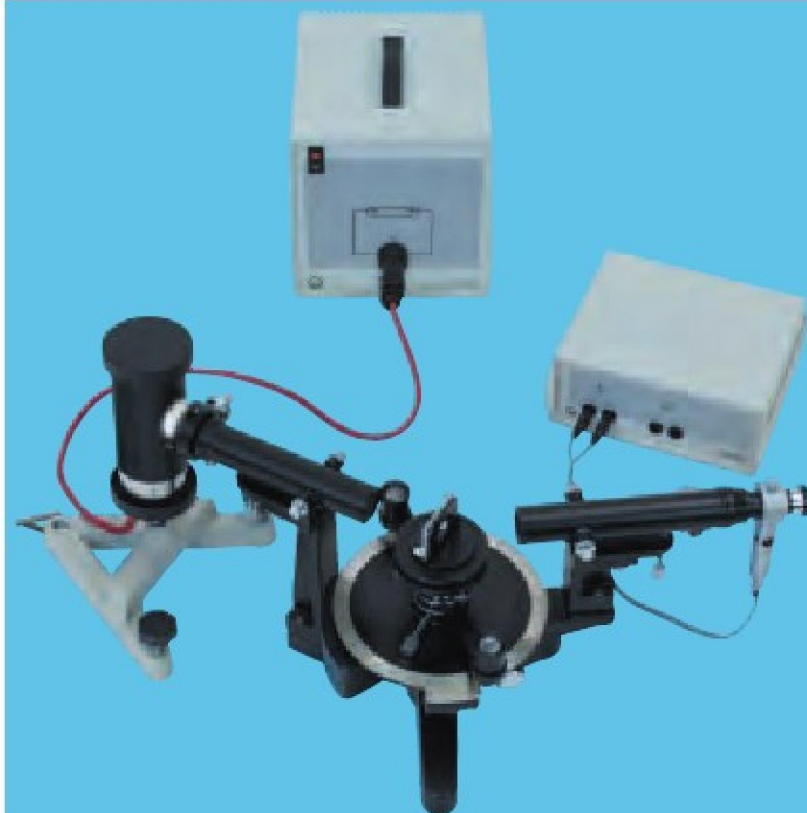
Pomiar linii widma gazów obojętnych i oparów metali za pomocą spektrometru pryzmatycznego (P5.7.2.1)
