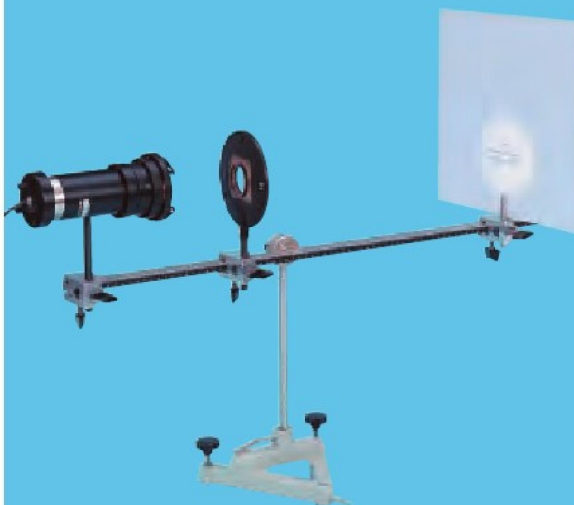
Określanie długości ogniskowej soczewek zbierających wykorzystując metodę Bessela (P5.1.2.3)
