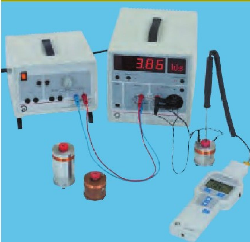
Przetwarzanie energii elektrycznej w ciepłą. Pomiar za pomocą dżu omierza i watomierza (P2.3.4.2_c)
