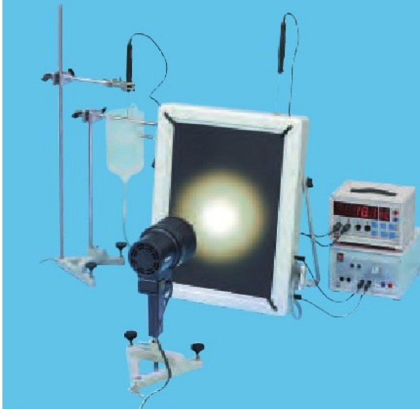
Ustalenie sprawności kolektora słonecznego w funkcji przepustowości objętości wody (P2.2.2.1_a)
