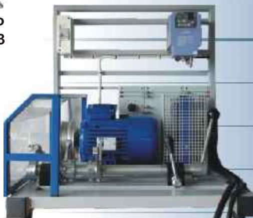
Stanowisko do badania alternatorów
