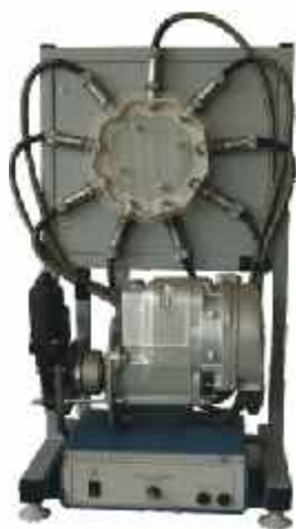
Stanowisko demonstracyjne iskrownika lotniczego
