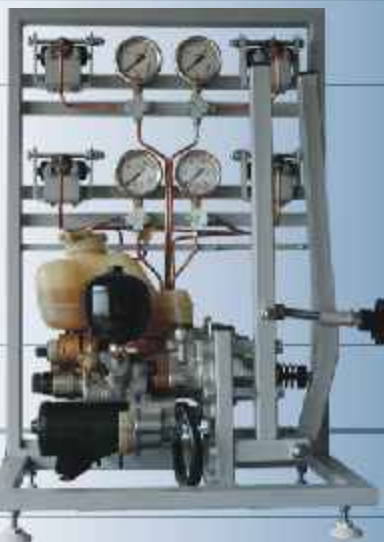
Stanowisko do badania układu hamulcowego z pompą MKII
