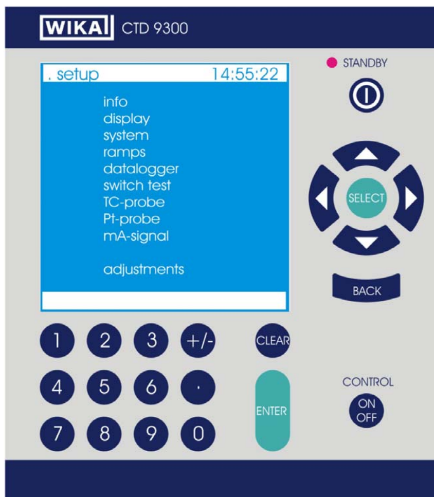
Rys.9: Menu ustawień z interfejsem użytkownika kalibratora CTD 9300
