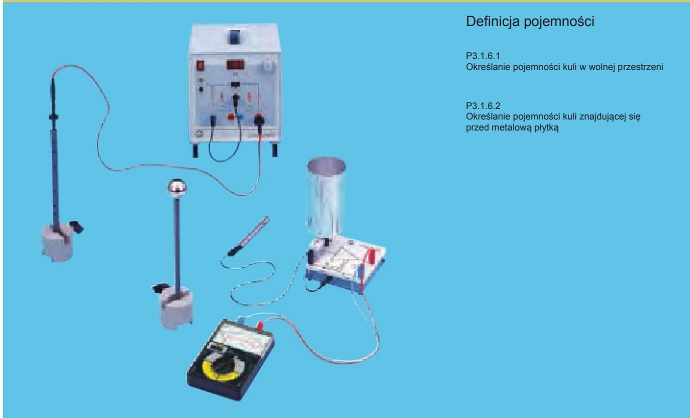
Określanie pojemności kuli w wolnej przestrzeni (P3.1.6.1)
