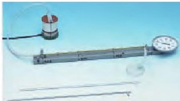
Rozszerzalność cieplna ciał stałych. Pomiar za pomocą rozbudowanego urządzenia (P2.1.1.2)
