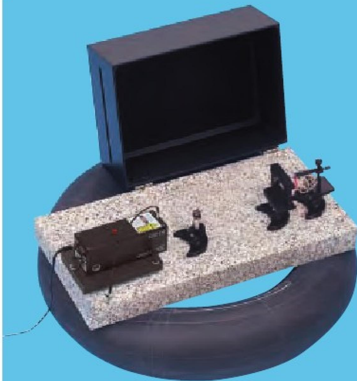
Tworzenie hologramów odbitego światła na płycie optycznej z laserem (P5.3.6.1)
