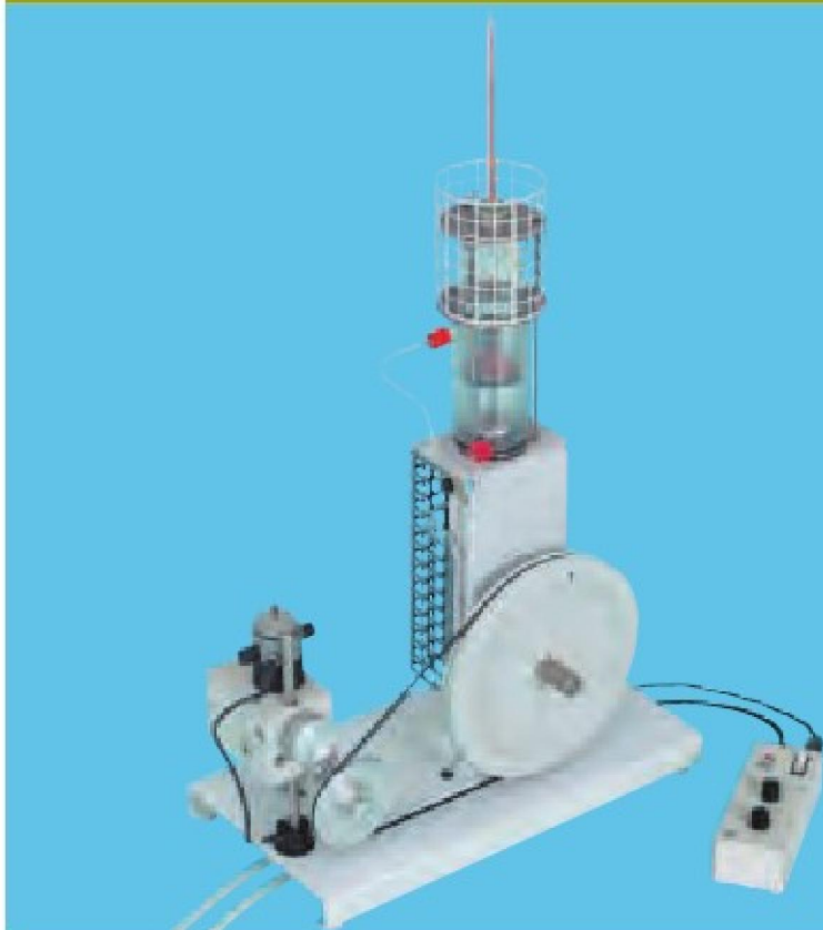
Praca silnika na gorące powietrze jako pompy ciepłej i chłodziarki (P2.6.1.3)
