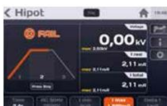
Test zakończony niepowodzeniem
